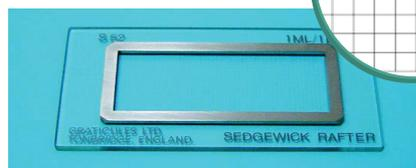
A câmara de Contagem Sedgewick Rafter é usada, principalmente, e para a análise de microorganismos (plânctons) presentes em água e em outros líquidos transparentes. A Câmara quadriculada (reticulada) é utilizada na contagem de célula fitoplânctica com capacidade de 1 ml, enquanto que a câmara lisa (sem retículo) é utilizada na contagem de células relativamente grandes permitindo realizar observações menores que 200x.
